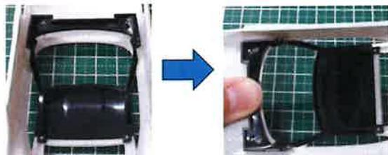
上部を指で押さえながら黒の窓枠部分（ピラー）を押し上げ、両側を写真と同じところまでのせあげます。
